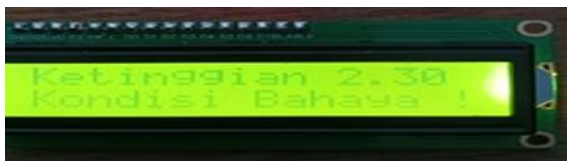
Sumber: Hasil Penelitian (2023) Gambar 7 Tampilan hasil pembacaan sensor di LCD
