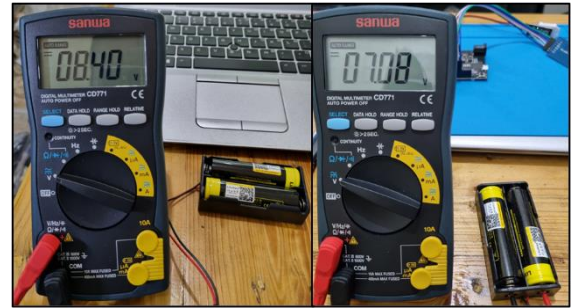
Gambar 7. Pengukuran tegangan baterai sebelum dan setelah pengujian sistem
